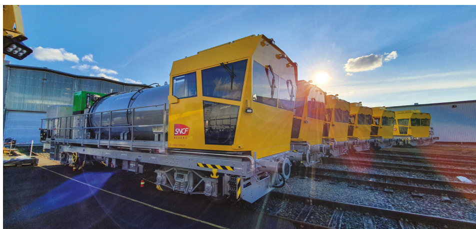
Figure 3-30 : Train désherbeur (SNCF Réseau)
