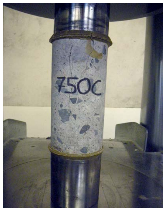
Figure 14 : Essais de carbonatation et essais de compression sur carottes
