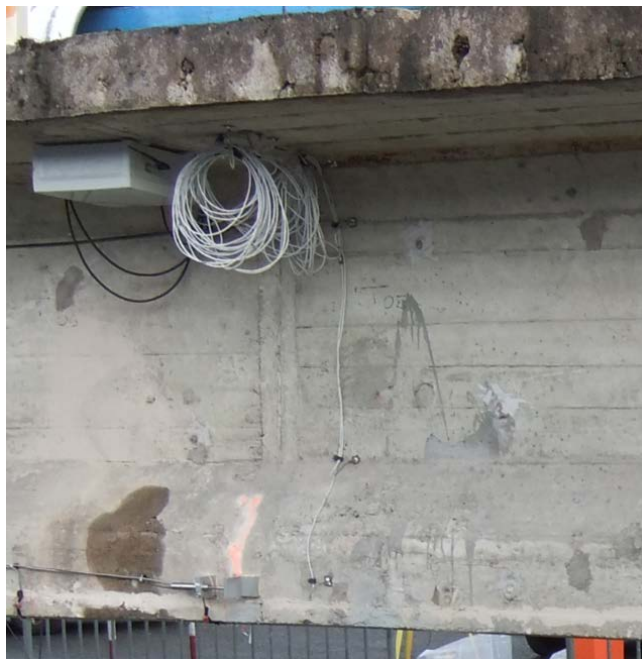
Figure 13a 13b : Mesures de gradients thermiques sur ouvrage afin d'affiner les hypothèses de calcul
