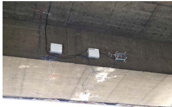
Figure 18b : Suivi de tension dans les câbles de précontrainte : évaluation des surtensions subies.
