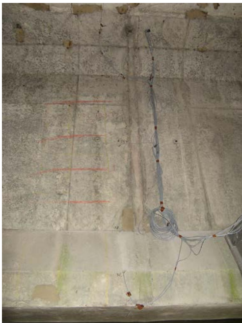
Figure 13a 13b : Mesures de gradients thermiques sur ouvrage afin d'affiner les hypothèses de calcul
