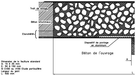
Dispositif de pontage standard Largeur: 200 mm Epaisseur: 1.5 mm
