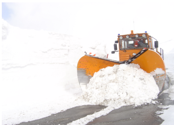
Figure 6 : photographie d'un véhicule portant une étrave (Source : CETE Normandie-Centre)
