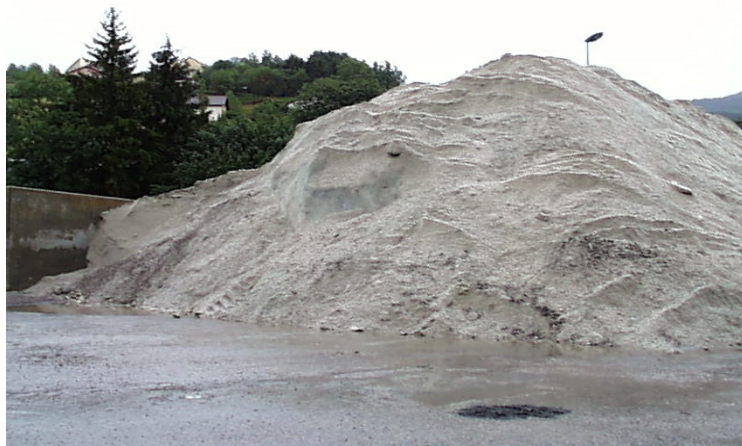
Figure 1 : le stockage du sel à l'air libre est peu recommandé car il favorise la dispersion du produit et la formation de lixiviat 1 du fait des précipitations. (source – CETE NC)
