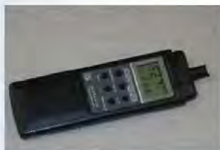
Mesure de la Température atmosphérique et de l'humidité relative. Détermination du point de rosée
