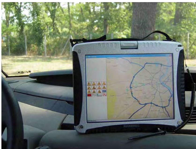
Appareil de géolocalisation par GPS embarqué dans véhicule – Logiciel SERPE. Photo CETE du Sud-ouest.
