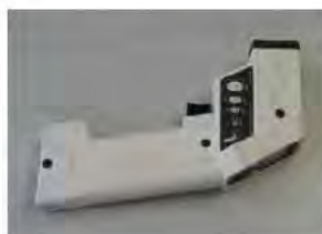
Mesure de la température de surface au moyen d'un appareil optique infrarouge
