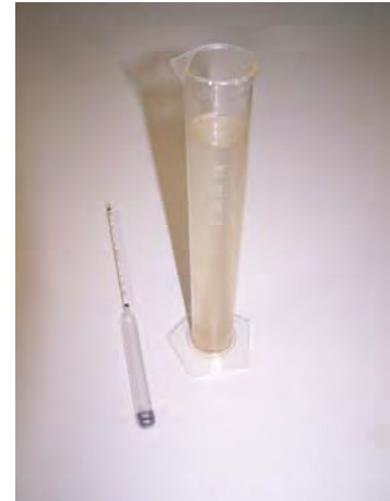
Exemple de densimètre
