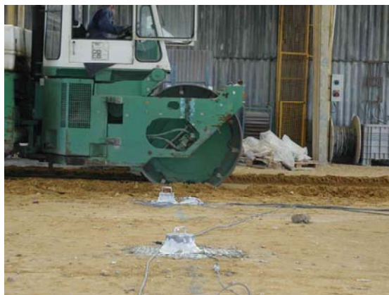
Figure 1 : compacteur et capteurs de vibrations lors d'une exp rimentation au CER (photo : CER de Rouen)
