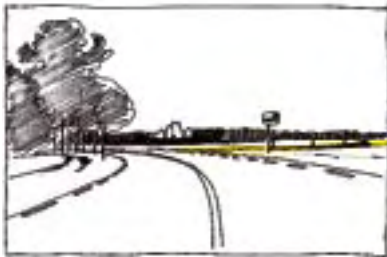
Risque d'éblouissement des usagers de la RN par ceux de la voie secondaire
