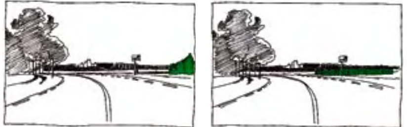
Éviter l'éblouissement en plantant une baie ou un taillis Source : Dominique Guy (CETE Normandie-Centre)
