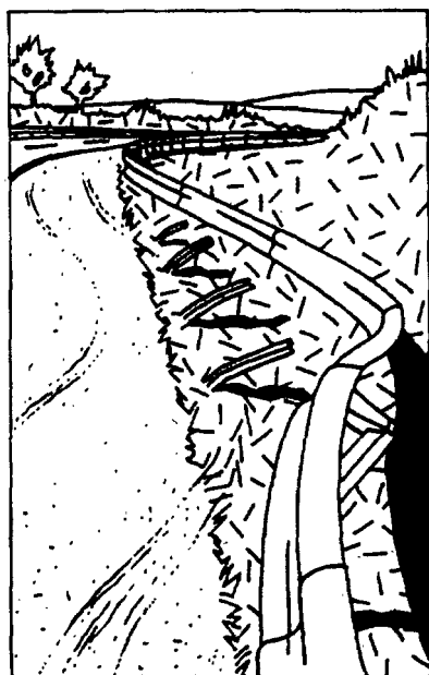
Absorption d'énergie. non franchissement, rebond faible.
