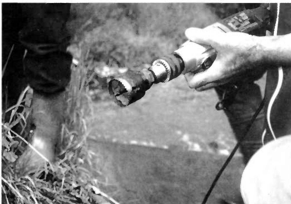
Figure 2.5. : Perceuse équipée d'une scie "cloche"
