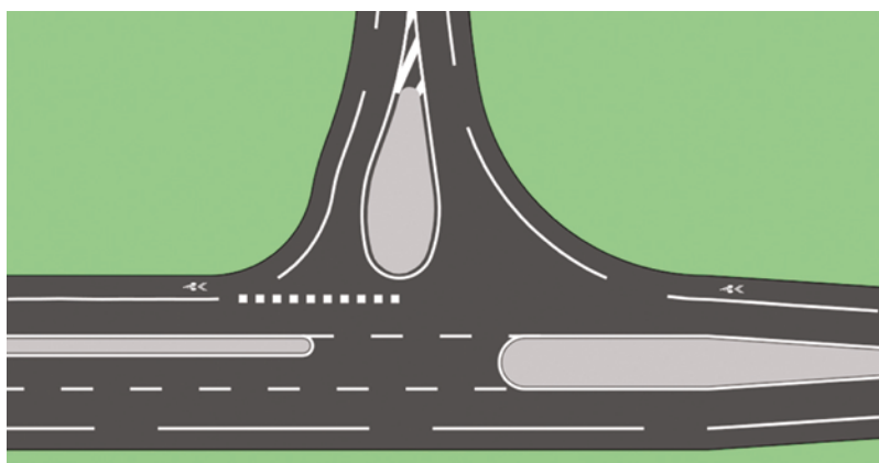
Figure 27 : Cheminement des cycles empruntant la BDD 122 au droit d'un carrefour plan ordinaire
