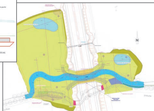
Profil en travers de l'ouvrage du Bras d'Altorf et plan masse des aménagements écologiques effectués au droit du cours d'eau. Étude de projet du contournement Ouest de Strasbourg. SOCOS/SINBIO.
