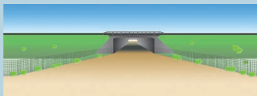
2 Schéma d'implantation des clôtures ne laissant pas les dépendances vertes accessibles à la faune. À l'approche de l'ouvrage, même si les dépendances ne sont pas accessibles, la disposition des clôtures en forme « entonnoir » permet de guider la faune vers l'entrée du passage. Source : Cerema.
