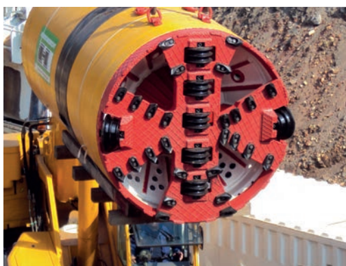
Mise en place d'un microtunnelage sur une voie ferroviaire. Source : Christian Chéreau - SNCF Réseau.
