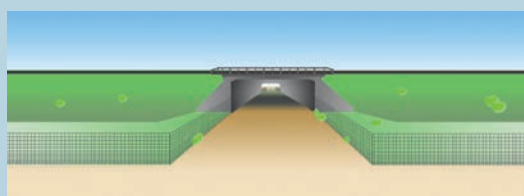
3 Schéma d'implantation des clôtures ne laissant pas les dépendances vertes accessibles à la faune et dont la disposition à l'approche de l'entrée de l'ouvrage crée un effet couloir défavorable au passage de la faune. Source : Cerema.
