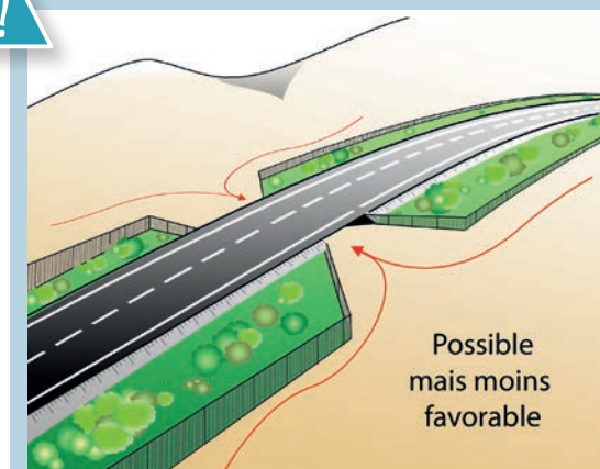
2 Schéma d'implantation des clôtures ne laissant pas les dépendances vertes accessibles à la faune. À l'approche de l'ouvrage, même si les dépendances ne sont pas accessibles, la disposition des clôtures en forme « entonnoir » permet de guider la faune vers l'entrée du passage. Source : Cerema.
