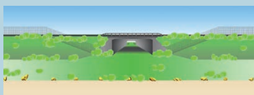
1 Schéma d'implantation des clôtures permettant à la faune d'accéder aux dépendances vertes et d'être guidée jusqu'aux ouvrages de franchissement. Source : Cerema.
