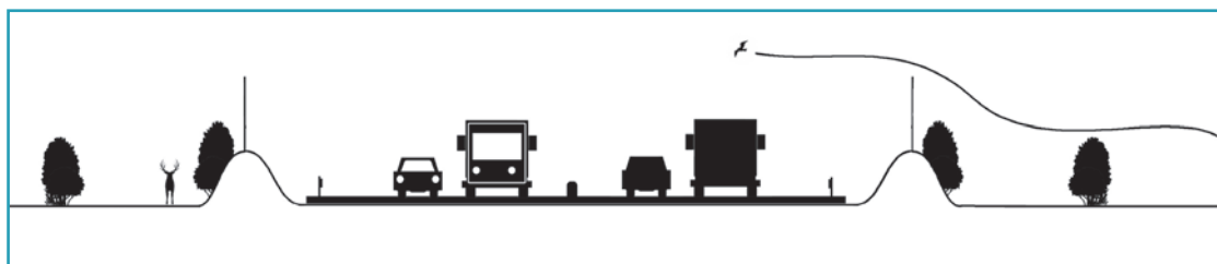
❶ Schéma d'aménagement de merlons de protection assurant la protection de la faune volante et la tranquillité des dépendances pour la faune terrestre. Source : Cerema.
