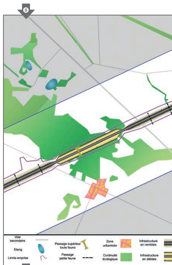
Études préalables : représentation schématique du tracé de l'infrastructure en plan, avec entrées en terre, position des passages à faune... Source : Cerema.
