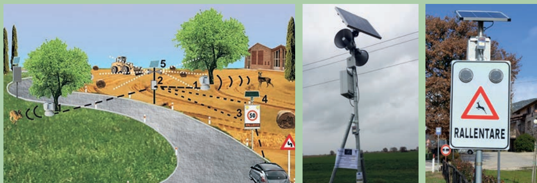
1 Illustration et photos du système d'alerte/effarouchement. Source : : http://www.lifestrade.it http://www.lifestrade.it
