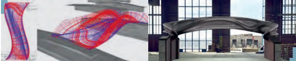
Illustration 13 : Pont piéton imprimé en 3D et conçu par Generative design. (Source : Mx3D)
