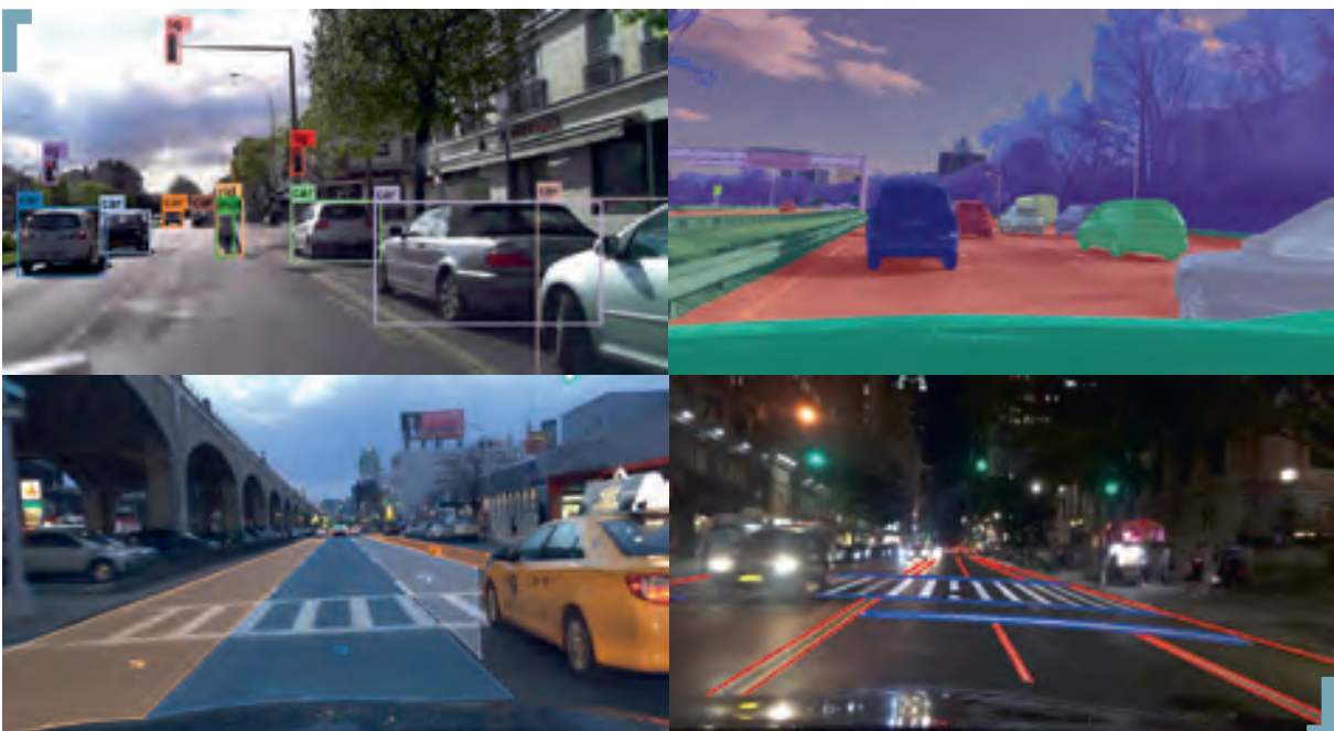
Illustration 11 : Informations sémantisées utilisables par un véhicule autonome. (Source : University of California, Berkeley - Berkeley DeepDrive)
