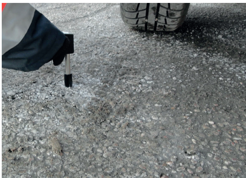
Photo 3 : Comblement de la microtexture par du dihydrate de sodium (source : Cerema / Laboratoire de Nancy)
