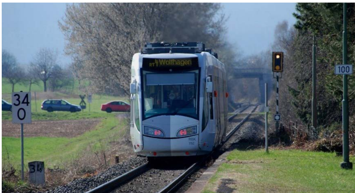
Le tram-train Alstom RegioCitadis « en vue arrière » approchant d'un passage à niveau franchissable à 100 km/h dans la région de Kassel. On reconnaît une signalisation et des installations simplifiées (voie unique, traction autonome, ici en diesel, halte avec quai enherbé), mais en bon état ! (Source : Wikipedia)
