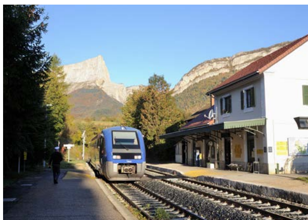
L'autorail Alstom X73500 à gauche en gare de Clelles-Mens sur la ligne Grenoble-Gap, le tram Rhônexpress (matériel Stadler Tango) au niveau de l'aéroport de Lyon St-Exupéry à droite. Les deux matériels ont une capacité similaire (onze sièges de plus dans le Tango mais sans toilettes ni rack à vélos), pourtant le Tango est 20 % plus léger – et presque moitié plus léger par essieu, étant sur six essieux au lieu de quatre – car conçu comme un tram et non comme un train (Sources : B. Meignien, Cerema, 2018 et R. Désormière, SNCF Réseau, 2010)
