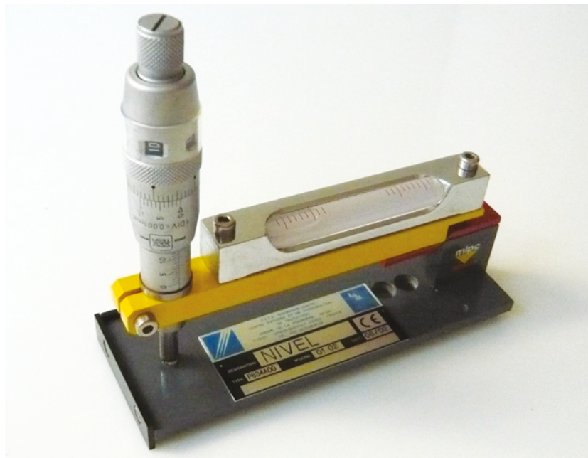
Figure 44 : Exemple de nivelle à vis micrométrique pour la mesure des inclinaisons (Matériel MLPC)
