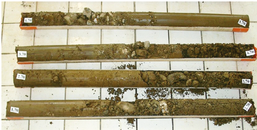
Figure 37 : Carottes mettant en évidence une structure de remblai « sandwich », avec des contrastes de perméabilité importants (Source : Cerema Sud-Ouest)
