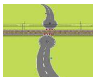
Figure 16 : Exemple de suppression de PN en impasse
