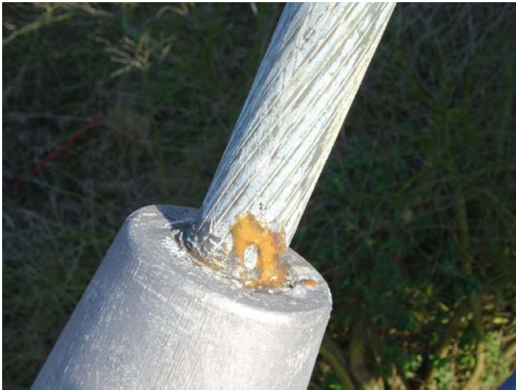
Figure 11 : Exemple de câble clos à fils Z
