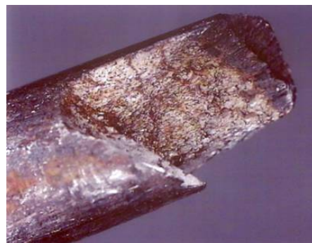
D - Rupture par corrosion fissurante sous contrainte
