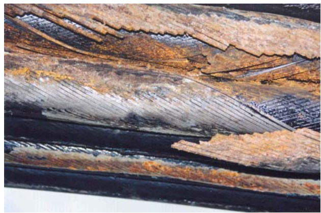
D - Fretting fatigue – frottements torons / torons
