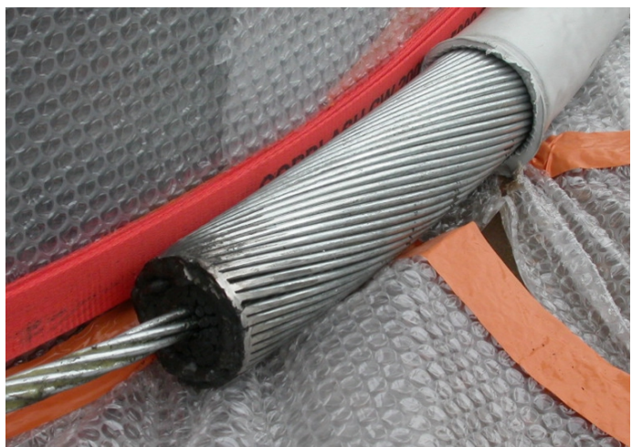
Figure 10 : coupe d'un câble Toron Multi Couches
