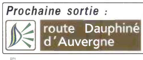
Panneaux de type H20 servant à la signalisation de balisage des itinéraires de découverte.
