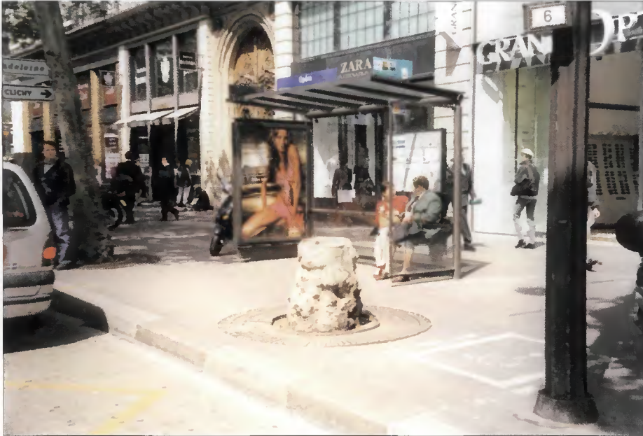
Exemple de positionnement d'obri-voyageurs en retrait du bord du trottoir, Paris, Arrêt Opéra (bd des Capucines), ligne 20 (source: IDF Conseil)
