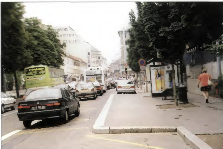
Point d'arrêt en avancée de trottoir, Strasbourg, Halle Sébastopol (source : IDF Conseil)
