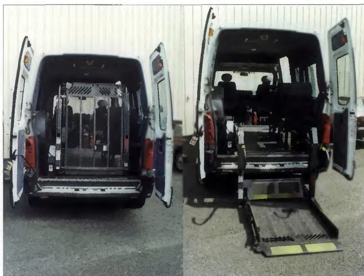
Le véhicule type de Transadapt vues sur l'élévateur arrière électrique, avec un aspect transparent (source: CERTU)
