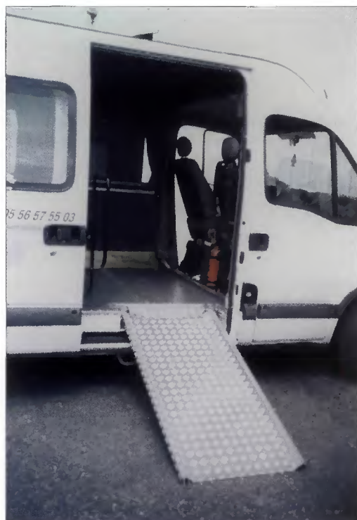
Le véhicule type de Transadapt sur base Renault Master, vue sur la palette latérale (source: CERTU)
