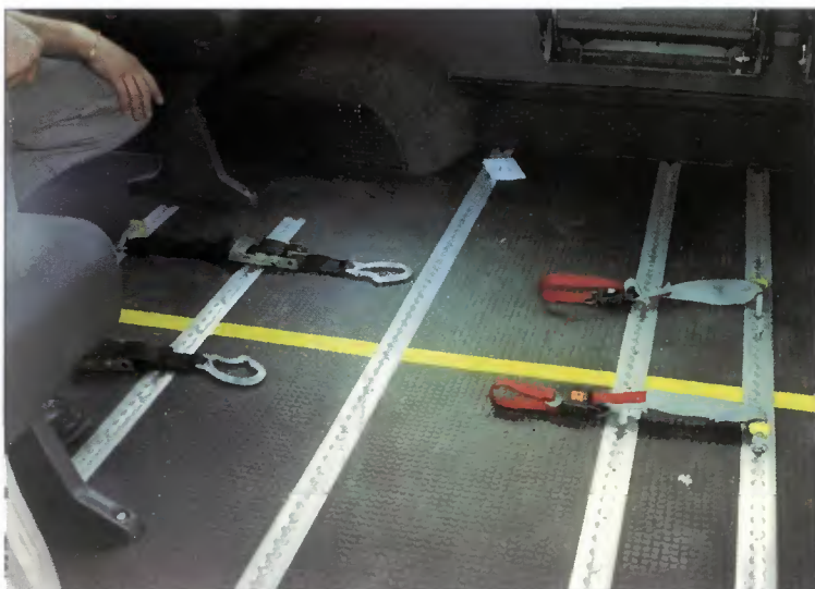
Véhicule Peugeot Boxer du GIHP (Montpellier), avec rails intérieurs pour l'arrimage des fauteuils roulants (source: CERTU)
