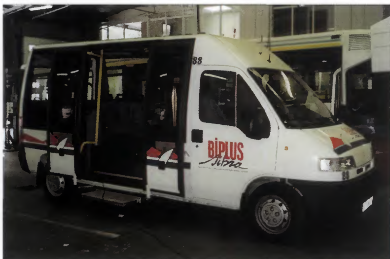
Le véhicule exploité sur la ligne BIPLUS à Annecy, avec une marche rétractable et une palette pour l'accès latéral du fauteuil roulant (source : CERTU)
