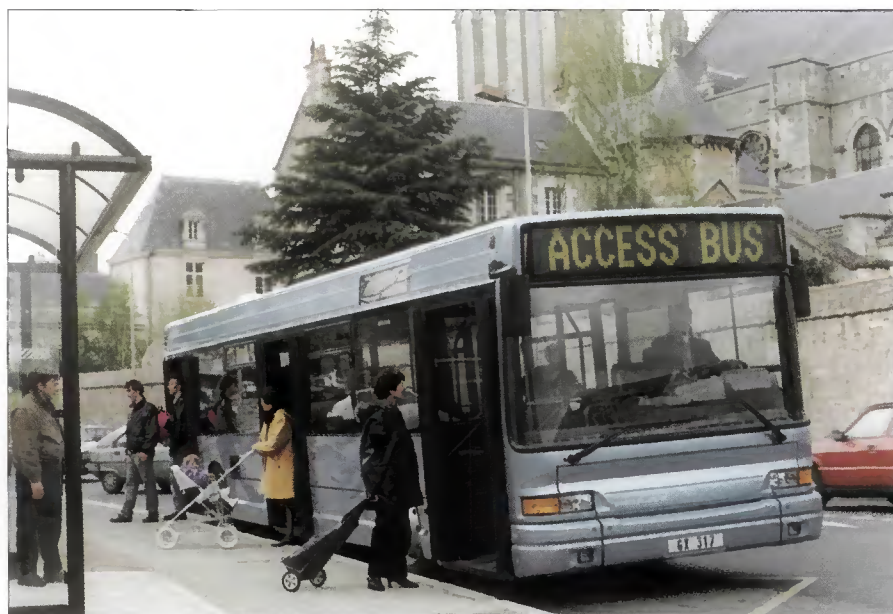
Exemple d'autobus standard, l'Access'bus, avec seuils des 2 portes avant à 320 mm (source : Heuliez Bus)
